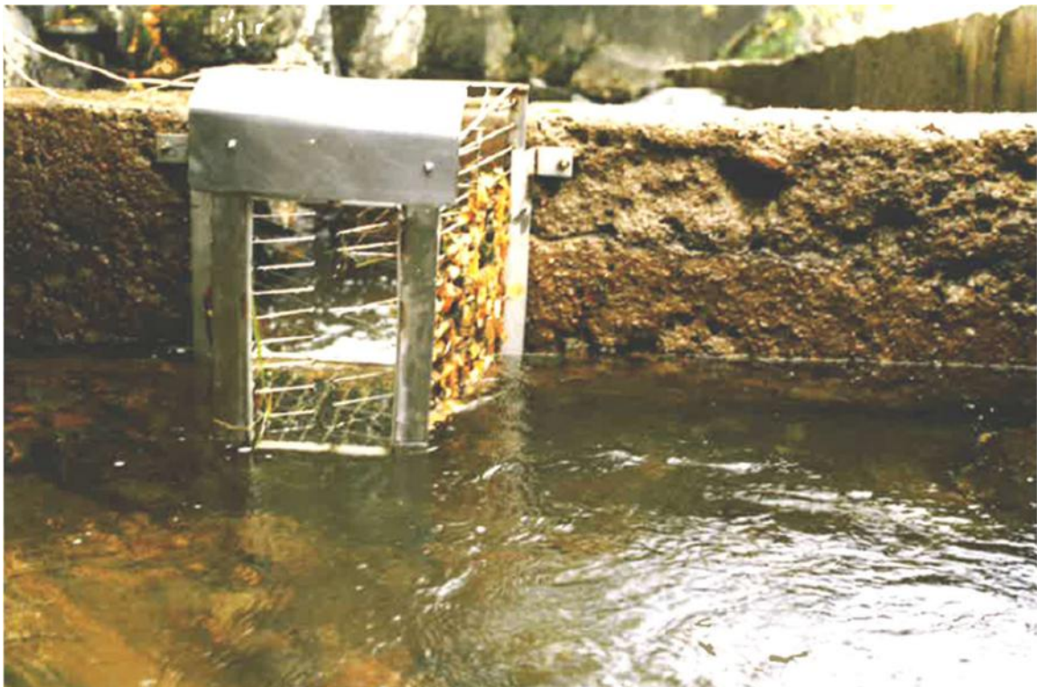
Valokuvat 39 ja 40. Vuonna 1996 lohimääriä laskettiin porrasaukkoon asetetulla mekaanisella laskurilla. Mekaanisen laskurin avautuviin metallisauvoihin tarttui ajelehtivää heinää ja puiden lehtiä, mikä häytti laskurin toimintaa. Ylempi kuva lohen noususuunnasta ylöspäin ja alempi kuva alavirtaa kohti. Valokuva Kjell Moen.
