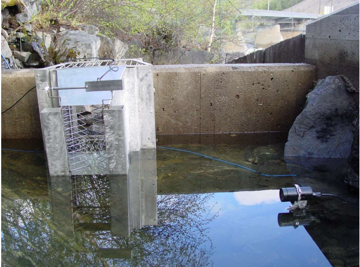
Valokuva 42. Vuosina 2002 ja 2003 siirryttiin pääasiassa kalojen vedenlaiseen videolaskentaan ja samalla tutkittiin mekaanisen laskurin tulosten paikkansapitävyyttä. Valokuva Jorma Kuusela.
