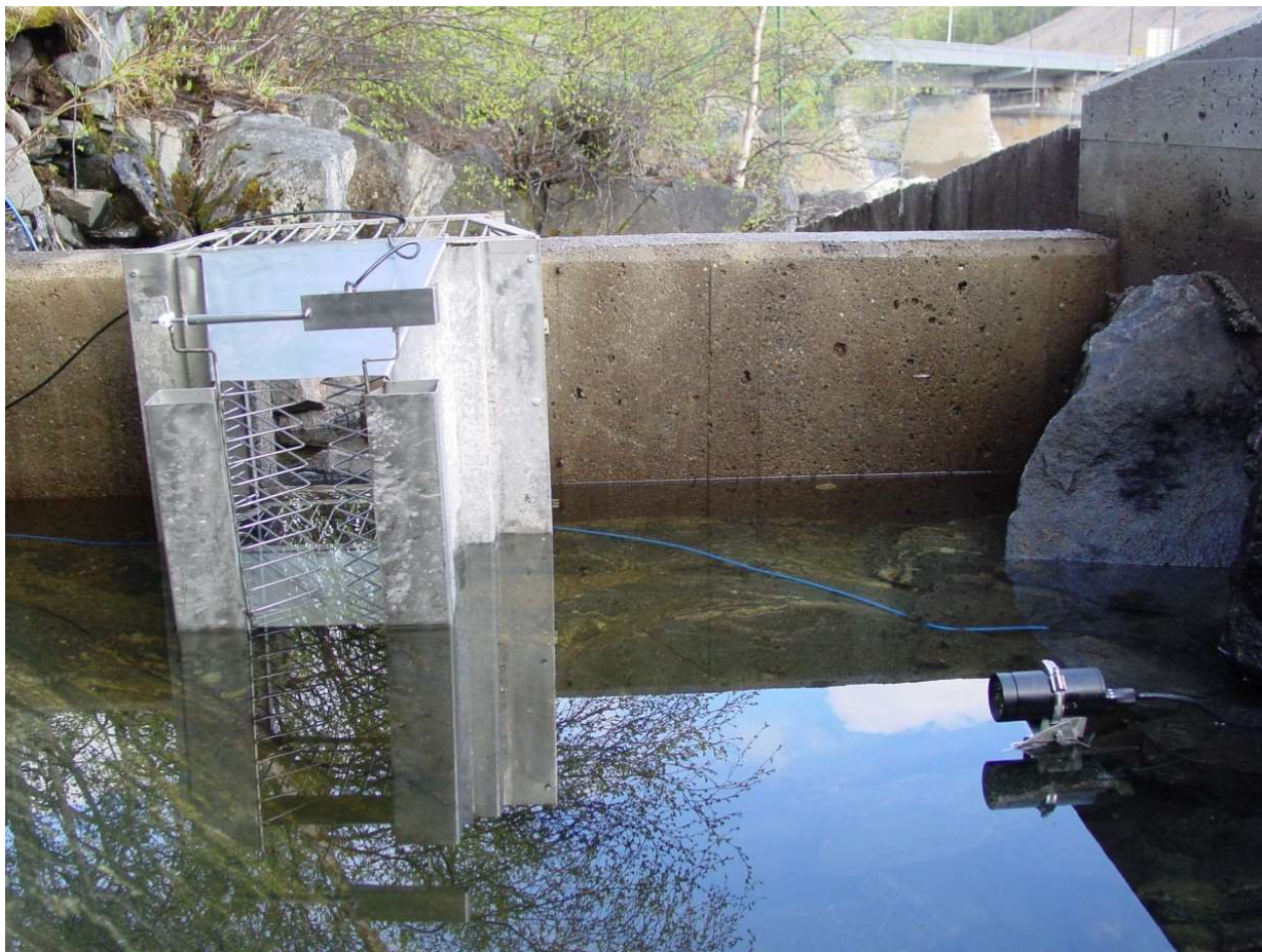
Foto 42. I årene 2002 og 2003 gikk man hovedsakelig over til videotelling av fisk under vann, og samtidig testet man om resultatene fra den mekaniske telleren stemte. Foto Jorma Kuusela.
